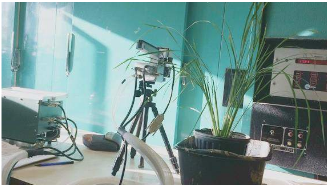
Figura 24 - Avaliação de biótipos de arroz-daninho com o medidor portátil de fotossíntese Li-Cor 6400XT. UARK, Fayetteville, AR, EUA, 2016.
