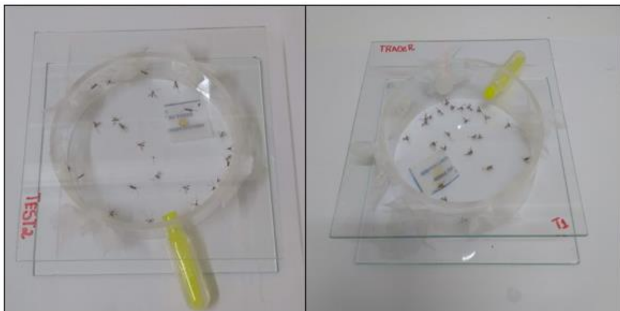
Fig. 2 Gaiolas utilizadas para confinamento de adultos de D. longicaudata para a exposição aos resíduos de pesticidas. Compostas por duas placas de vidro e um anel intermediário de metacrilato.
